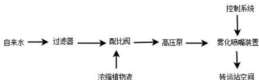
图 2-5 除臭工艺流程示意图
